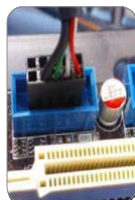
USBコネクタをマザーボードに接続します。
