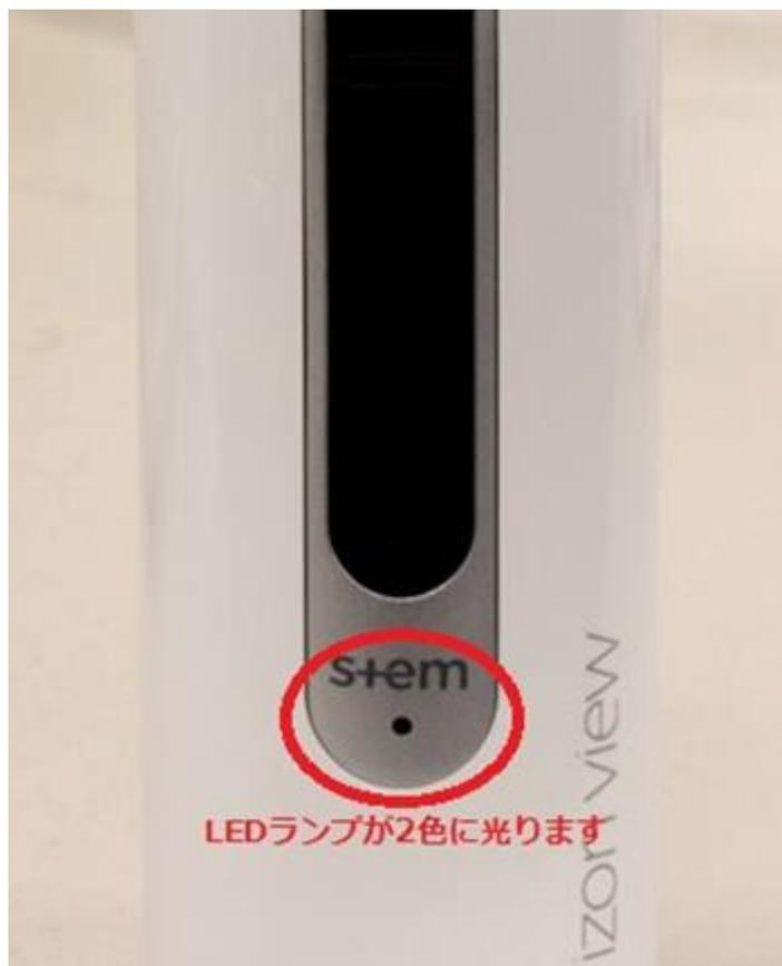
本体に搭載されております LED ランプの点灯状況で通信状態を確認することができます。
