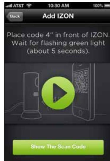
QRコードをIZONで認識させるために、iOSデバイスの画面をIZONの約10cm前に設置するとカメラ機能が働き、自動で認識されます。
