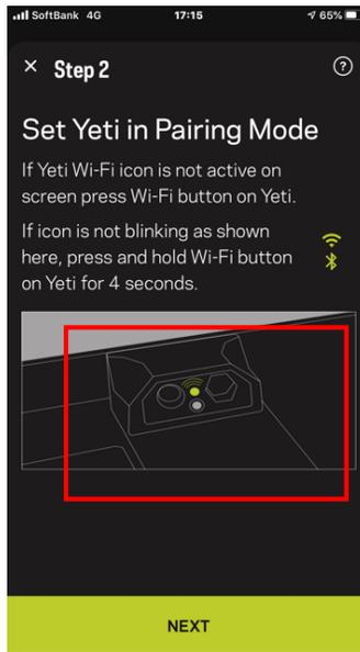
STEP2.ペアリングするために、Yeti本体の天板の中にある、WiFiのボタン(上)を4秒ほど長押しします。音が鳴り、Yeti本体のディスプレイにWiFiとBluetoothのアイコンが点滅します。（Bluetoothのアイコンは2020年以降のモデルのみです）
