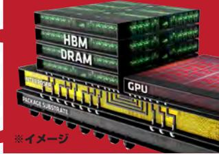
HBMは、メモリチップを縦に積み上げて、高帯域幅なバスで繋ぐ。高帯域幅なメモリは、グラフィックスボードのパフォーマンスを向上させる。さらにHBMメモリを搭載することで、メモリの実装面積が小さくなりボードの小型化が可能になる。
