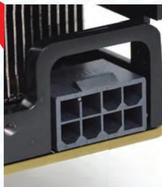
補助電源コネクタ 8PIN 1系統
