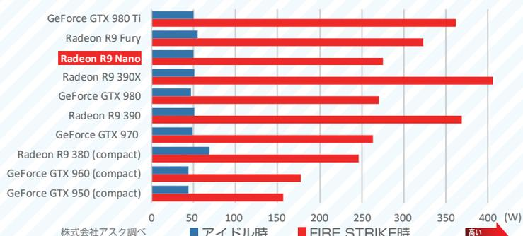
Radeon R9 Nano は、ワットあたりのパフォーマンスは、GeForce GTX 980 を上回る。Radeon R9 Fury の消費電力を考えるとかなり低消費電力設計である。
