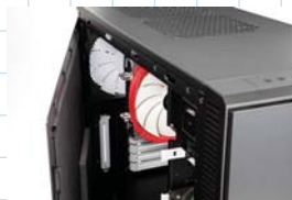
側面パネルの干渉は発生してしまうと対処が難しい。今回使ったFractal Designの「Define R4」のように、背の高いCPUクーラーへの対応をうたったPCケースを選ぶと安心だ。
