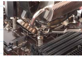
V8 GTSは六角ナットでクーラー本体を固定する。ナットを回すには付属のレンチを使うため、メモリーは外した方が作業しやすい。
