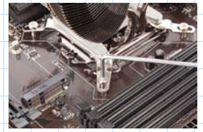
CNPS9900MAXは六角レンチを使う。少しずつしか回せないため、時間がかかる。VRMのヒートシンクにも引っかかりやすい。
