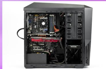
パーツを一式組み込んだところ。マザーボードベースが短く、裏面へ太いケーブルが通しやすい構造です。
