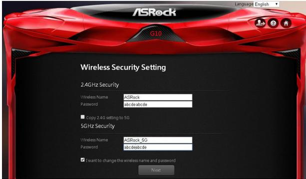
「I want to change the wireless name and password (デフォルトのワイヤレス名とパスワードを変更する)」を選択して、テキストボックスに希望するワイヤレス名とパスワードを入力します。
