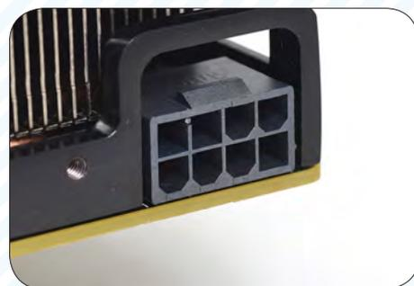
省電力設計により補助電源は、8 Pin が 1 個である。
