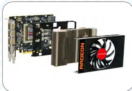
GPU チップの熱は、ヒートパイプを利用して放熱フィンに伝わる。
