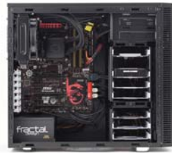
チューブが長めなので若干たるみができる。上面ファンやグラフィックスボードの有無でラジエーター側の接合部を上下どちらに向けるか決めるとよいだろう。
