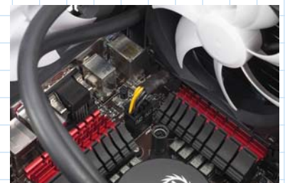
マザーボードのレイアウトにもよるが、マザーボードの端にあるヒートシンクと干渉したり、端子にアクセスしにくいといった状況は生まれやすい。
