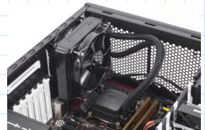
マザーボードのヒートシンクとはまず干渉しない。ただ CPU 用 +12V の端子にはアクセスしにくくなる。
