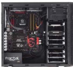
長さ 24cm のラジエーターは上面に取り付ける。横から見るとファンしか見えない。
