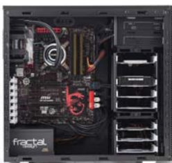
今回の 3 製品の中で最も他のパーツとの干渉が起こりにくいと思われる。ラジエーターの固定も背面ファンが 12cm 角に対応していれば OK で、導入のハードルは低い。
