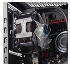
付属の長いねじを使うと、シャシーとの間に 12cm 角ファンを挟むことも可能。冷却能力を引き上げられる。
