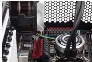
背面ファンの位置に付ける場合、バックパネルの分マザーボードから浮いた状態になるので、ヒートシンクとの干渉はまず起こらない。
