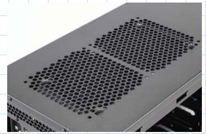
大型ラジエーターを使う際は、上面にファン用のねじ穴が必要。写真の「Define R4」(Fractal Design) のように、12cm 角、14cm 角用の穴があると安心だ。ちなみに、Define R4 は 12cm 角用の穴が 2 カ所空いており、干渉を避けるためにマザーボードから少し離してラジエーターを付けられるようになっている。
