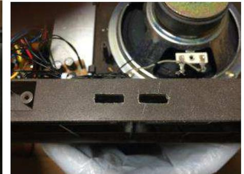
USB2.0は取り回しを考慮してピンヘッドを使用します。ケース底面に穴を開け、市販のフラケットを通して固定するのですが、USBの差込口は水性ペンでマーキングしてあたりをつけ、ピンバイスで穴を開けて最後はヤスリで仕上げます。根気の要る作業ですが完成度・満足度が高い作業です。
