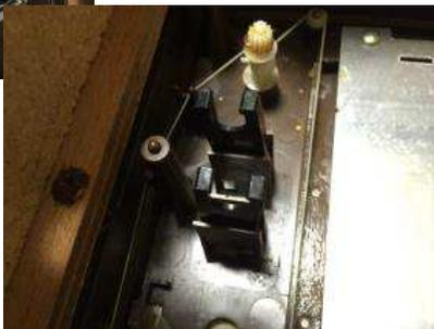
ラジオの基板をはがすと、チューニングダイヤル用の糸がかかっています。ダイヤルは基板側にあるのでこのギミックは使用できません。バンド切り替えのスライドスイッチは電源スイッチに流用します。
