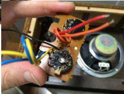
フロントのボリューム部。下段はボリュームとラジオの電源スイッチ機構があり、うまく利用するとアンプの電源ON/OFFと連動できそう。
