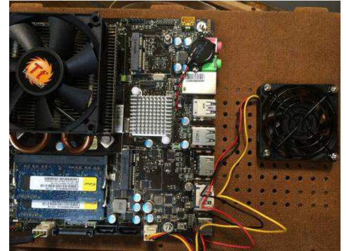
SSDの逃げ場がないので、天井にねじらーで固定。軽いからたぶん落ちないでしょう。また、給排気ができない構造でしたので、底に大穴を空けました。そこに40mmファンを埋め込むつもりでしたが、CPU温度が最大55℃程度で落ち着いたので、結局そのままにしています。マザーボード脇に60mmファンを追加しましたが、なぜかマザーボードのSYS1と相性が悪く、回っていません。そのうち他のケースファンに交換してみる予定です。
