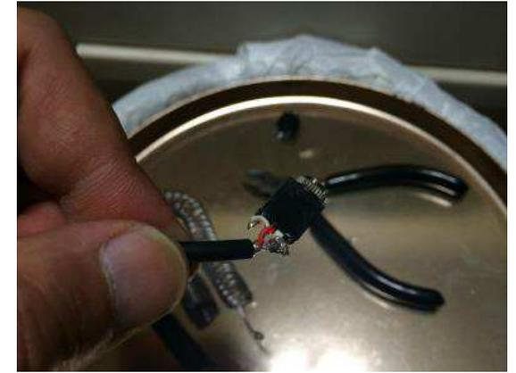
FM/AMラジオのアンテナはすべて取り除き、市販のφ3.5オーディオジャックを使用します。次に、市販のステレオミニプラグケーブル（オス-オス）を半分に切り、被膜します。これで2本取れます。
