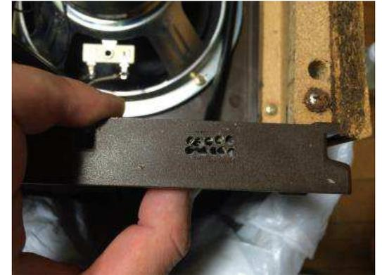
ねじ止めできない差込部は、ハリの部分にしっかり固定できるよう、位置決めして加工します。はみ出してしまうゴムはニッパーで切り取って型合わせします。穴の部分は水性ペンで絵を書いて、ピンバイスで穴を開けて、ヤスリで加工して・・・均一に削るには根気と時間が必要です。
